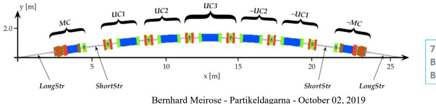
7 dipoles, Bending angle: 18<sup>0</sup> Bending radius: 19 m
