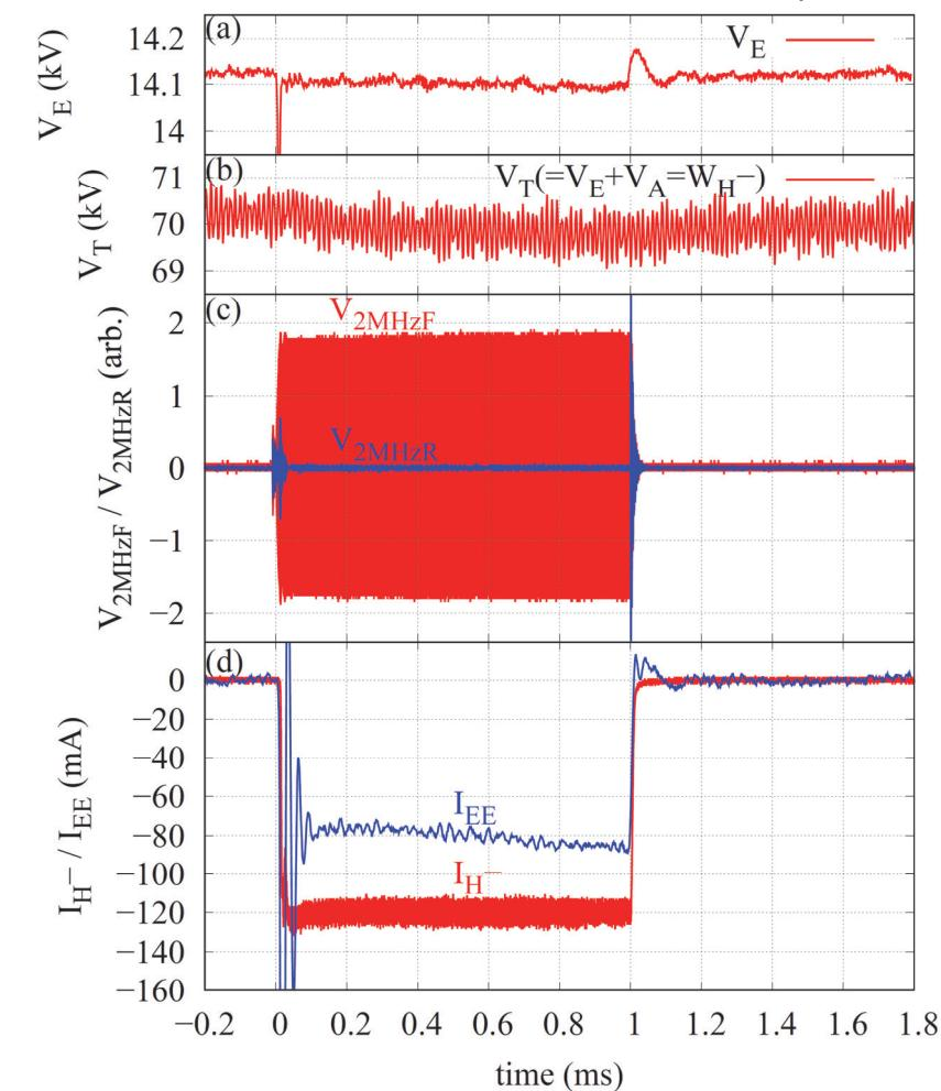
Waveforms of  $V_E$ (a),  $V_T$ (b),  $V_{2MHzF}$  &  $V_{2MHzR}$ (c) and  $I_{H^-}$  &  $I_{EE}$  (d) of one beam pulse.
