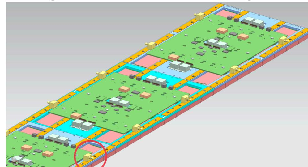
**Moduli:** matrici lineari di 16 barre di LYSO accoppiate su due lati a matrici lineari di 16 SiPM + elettronica di FrontEnd
