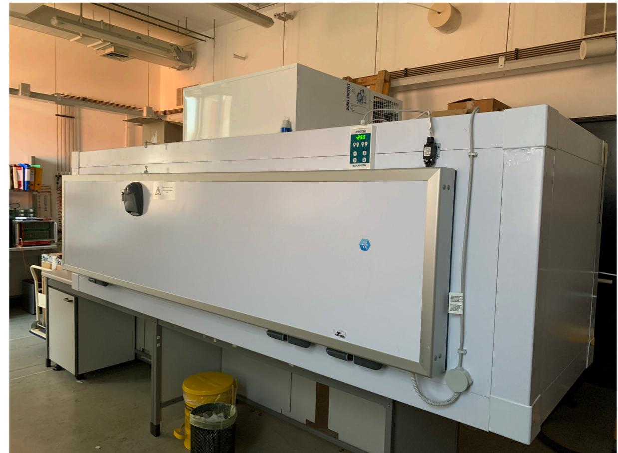
freezer da 2.5 m per il test dei tray a  $-30^{\circ}\text{C}$
