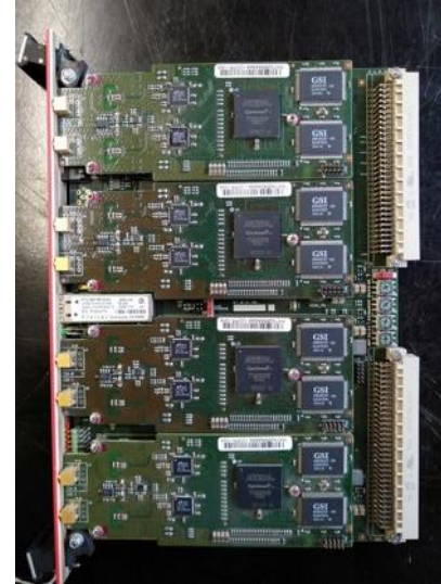
CAEN V1720 8ch, 12bits@250Mps
