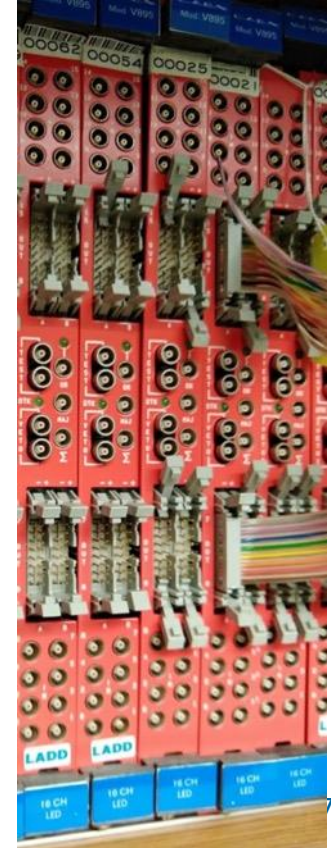
CAEN V1720 8ch, 12bits@250Mps
