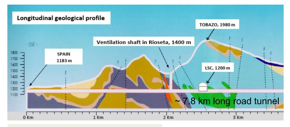
850 m under mount Tobazo (~ 2500 m.w.e) Muon flux ~  $4\times10^{-3}$  m<sup>-2</sup> s<sup>-1</sup> Inlet air flux ~ 20000 m<sup>3</sup>/h Radon level 50 - 80 Bq/m<sup>3</sup> Neutron (<10 MeV) ~  $3.5\times10^{-6}$  n/(cm<sup>2</sup> s) Gamma rays flux ~  $2/(\text{cm}^2 \text{ s})$
