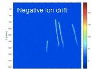
150 Torr  $CF_4$  + 5.9 Torr  $CS_2$ ,  $\sigma \sim 150 \mu m$
