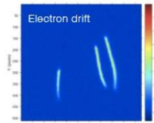
150 Torr  $CF_4$ ,  $\sigma \sim 450 \mu m$
