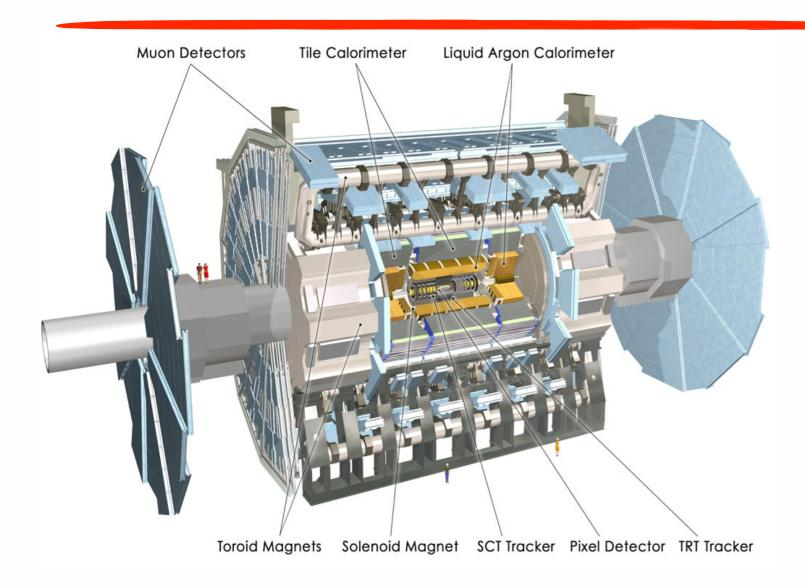
Muon Spectrometer ( $|\eta|$ <2.7):  $\sigma/p_T \sim 10\%$  (1TeV)
