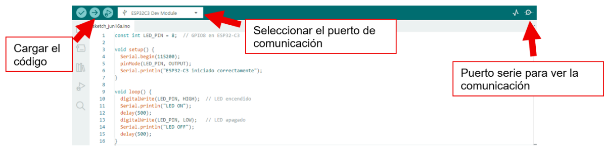
Figura 7: Cómo cargar el programa en el ESP32
