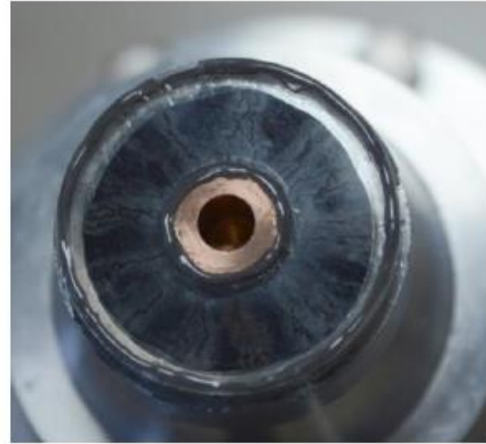
Şekil 6. Güç bağdaştırıcısının vakum penceresinin RFQ içi ve dışı tarafında oluşan arkların izleri
