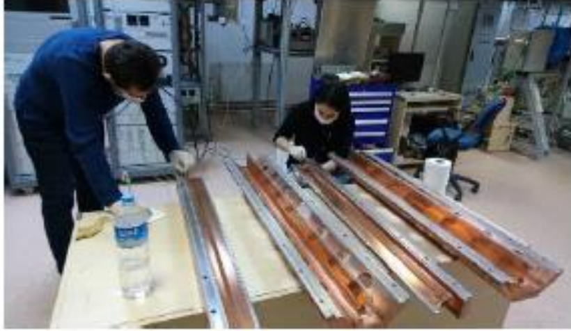
Şekil 2. İkinci kez kaplamadan önce temizlik ve parlatma işlemlerinin görüntüleri
