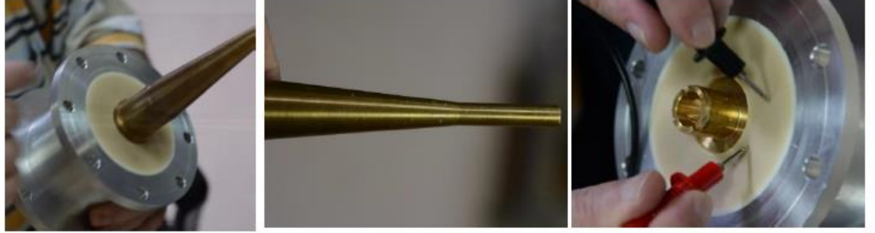
Şekil 5. Güç bağdaştırıcısındaki arklardan dolayı oluşan izler ve birikmiş metal buharları
