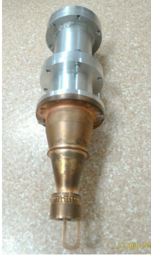
Şekil 5. Güç bağdaştırıcısındaki arklardan dolayı oluşan izler ve birikmiş metal buharları
