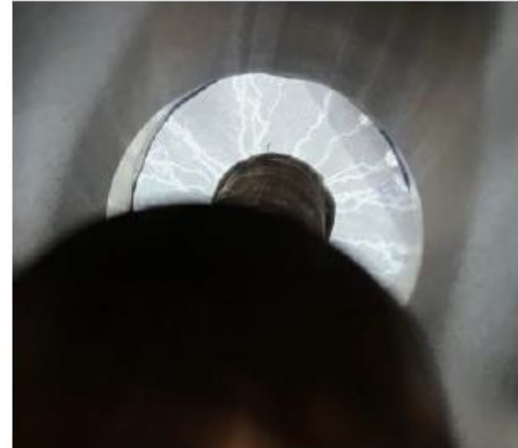
Şekil 6. Güç bağdaştırıcısının vakum penceresinin RFQ içi ve dışı tarafında oluşan arkların izleri
