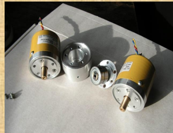
Датчик угла поворота на эффекте Холла
