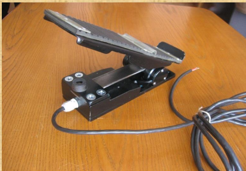
Электронная педаль для управления скоростью автомобиля
