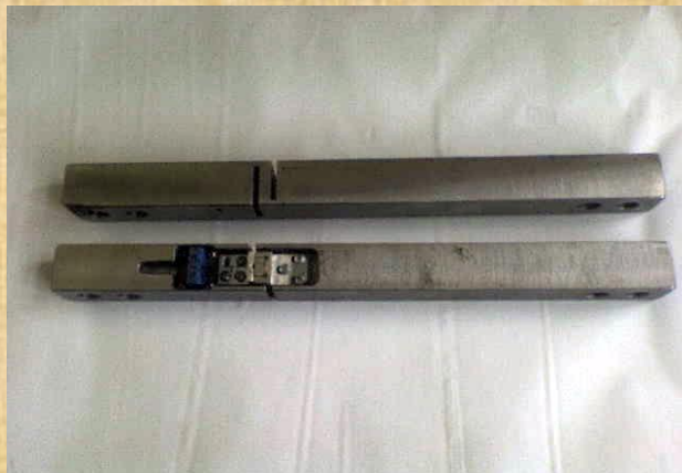
Датчик деформации – магнитный аналог тензорезистора
