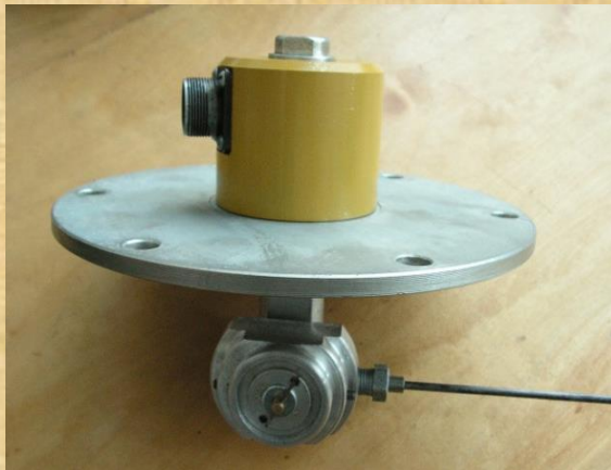
Электронная педаль для управления скоростью автомобиля
