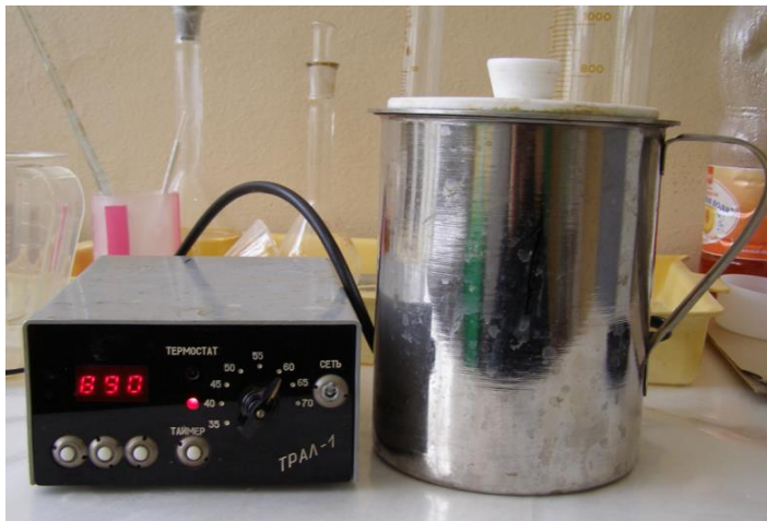
Прибор для травления трековых детекторов – термостат ТРАЛ-1
