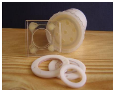
Прибор для травления трековых детекторов – термостат ТРАЛ-1
