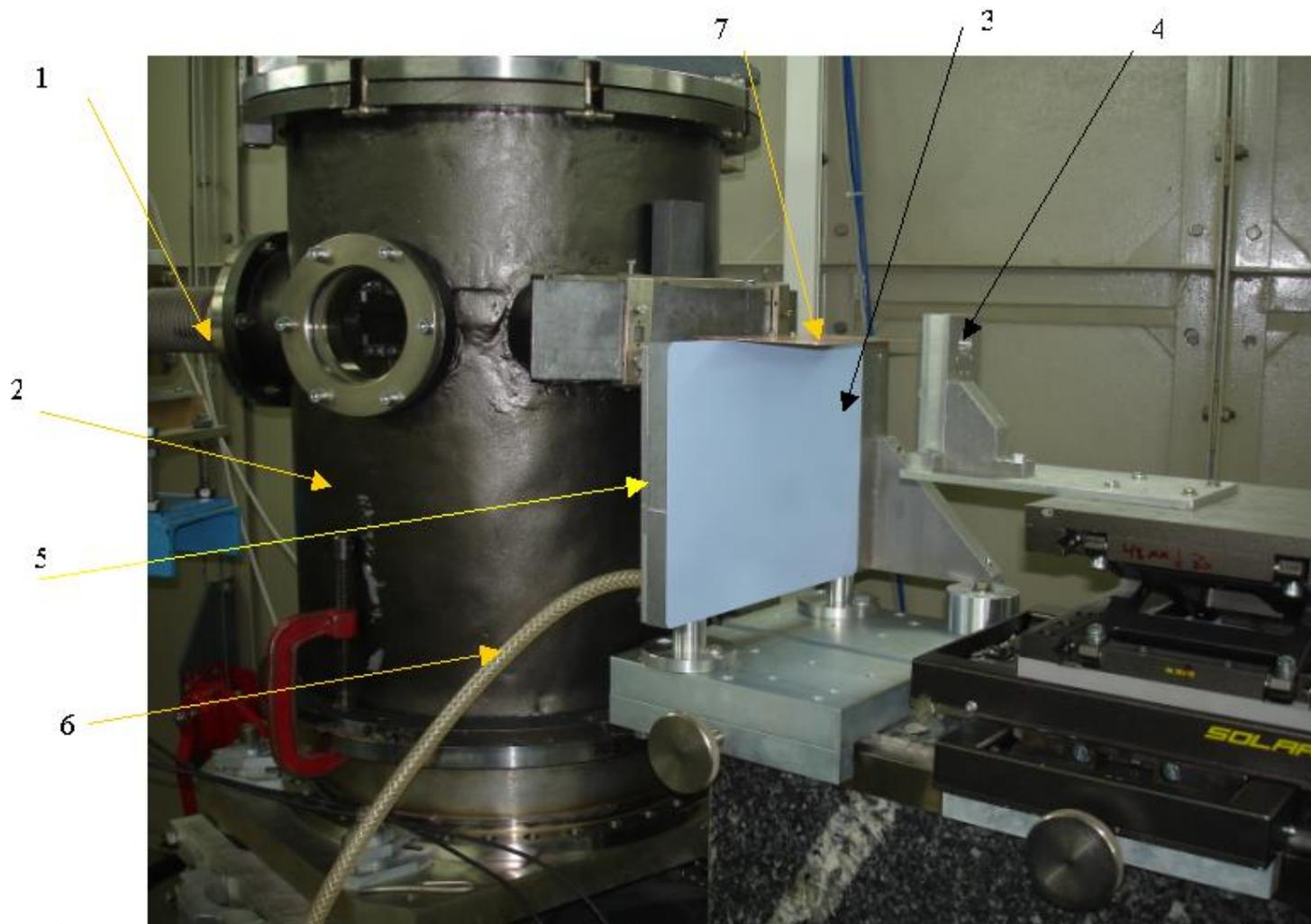
Экспериментальная станция для прецизионной регистрации дифрактограмм по методу Гуля/Дебая-Шерера в геометрии обратного рассеяния. 1- канал вывода СИ, 2 - вакуумно-гелиевый колпак монохроматора, 3. 2D детектор, 4 – кронштейн исследуемого образца, 5 – кронштейн-«присоска» регистрирующего экрана, 6 - шланг откачки «присоски» регистрирующего экрана, 7 - экран рассеянного на воздухе излучения. |
