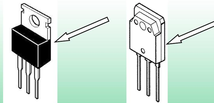
Схема ориентации активной области прибора относительно направления пучка частиц
