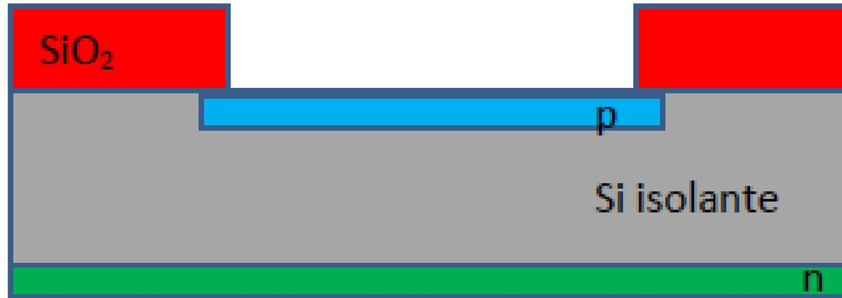
**Esquema do diodo PIN**
