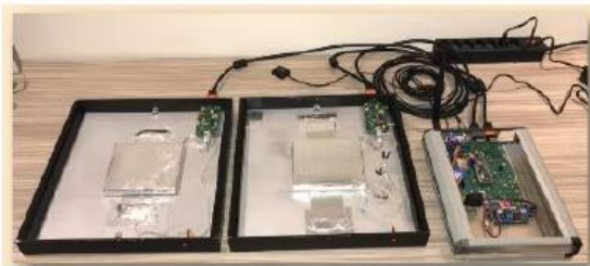
Figura 3 – Os dois detectores de raios cósmicos abertos
