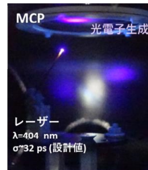
縦方向ビームプロファイルモニタとテストベンチ
